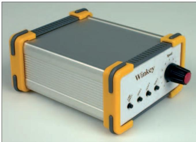
Nach kurzer Zeit lag die Sendung im Briefkasten. Also schnell eine Platine nach dem Original von K1EL gefertigt, aufgebaut und getestet. Und siehe da: einwandfreie Zeichengabe! Und ein externes Paddle ließ sich auch noch anschließen. Doch die Entwicklung ging weiter. K1EL programmierte im vergangenen Jahr einen neuen Keyer in einem PIC 16F688, und nannte ihn Winkey2. Er ist abwärtskompatibel zu Winkey, wird aber jetzt im 14-poligen DIL-Gehäuse geliefert.
