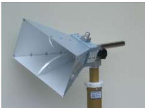
Bild: Hornantenne (Wikipedia)
