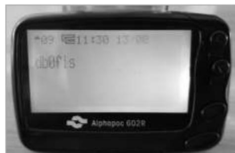
Das DAPNET ist ein von Funkamateuren betriebenes Funkmeldesystem auf 439,9875 MHz. Es besteht aus einem dezentralen Verbund von Servern und daran angeschlossenen Sendern.
