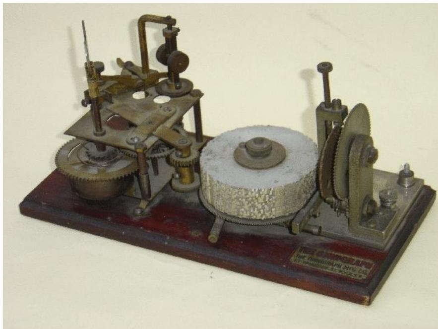
Abb. 7: Omnigraph: ein Morse-Übungsgerät um 1901. Ein Uhrwerk (links) drehte mit einstellbarer Geschwindigkeit einen Stapel von Metall-Scheiben, in deren Rand die Morsezeichen eingeklebt waren. Bei der Drehung betätigten sie einen elektrischen Kontakt. Der Kontakt rückte nach jeweils einer Umdrehung selbsttätig von einer Scheibe zur nächsten weiter.
