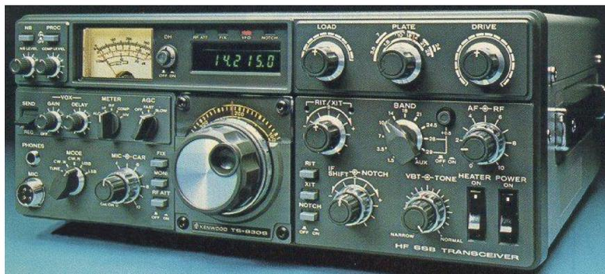
Abb. 13: Kurzwellen-Amateurfunkgerät 1981, vom Typ Kenwood TS-830. Eines der wenigen Hybrid-Geräte, die sowohl integrierte Schaltkreise und eine digitale Frequenz-Anzeige als auch (in der Sende-Endstufe) Röhren besitzen. Von den technischen Daten her können diese älteren Geräte mit den heute hergestellten Funkgeräten in der Regel mithalten und sind diesen nicht ganz selten überlegen. [<http://myweb.tiscali.co.uk/martin.atwsm>]
