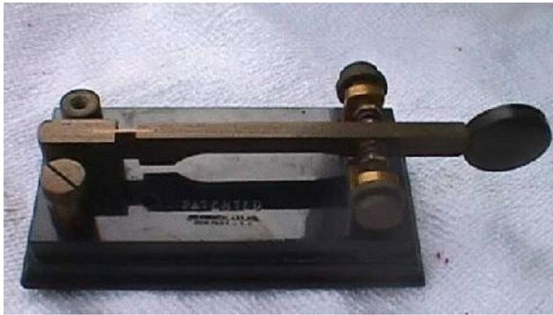
Abb. 2: „Double-Speed“-Taste; „Sideswiper“; (dt. Seitentaste) patentiert 1888 von Jesse H. Bunnell. Der Tastenhebel bewegt sich horizontal zwischen den beiden Kontakten rechts im Bild hin- und her. Dadurch wird ein schnelleres Geben möglich, als mit einer „normalen“ Handtaste. [<http://www.qsl.net/n6tt/pic/Bunnell-double-speedkey.jpg>]
