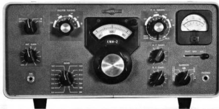
Abb. 12: Kurzwellen-Amateurfunkgerät 1959, vom Typ Collins KWM 2, vollständig mit Röhren bestückt. Legendär waren und sind die elektromechanischen „Collins-Filter“, die eine sehr hohe Trennschärfe haben. Viele der alten Röhrengeräte sind heute noch im Einsatz. Sie sind sehr robust, auf dem Gebrauchtmart preiswert zu haben und ein Funkamateurl kann sie im Gegensatz zu den heutigen hoch-integrierten Schaltungen meist selbst reparieren. [<http://www.rigpix.com/collins/kwm2.jpg>]
