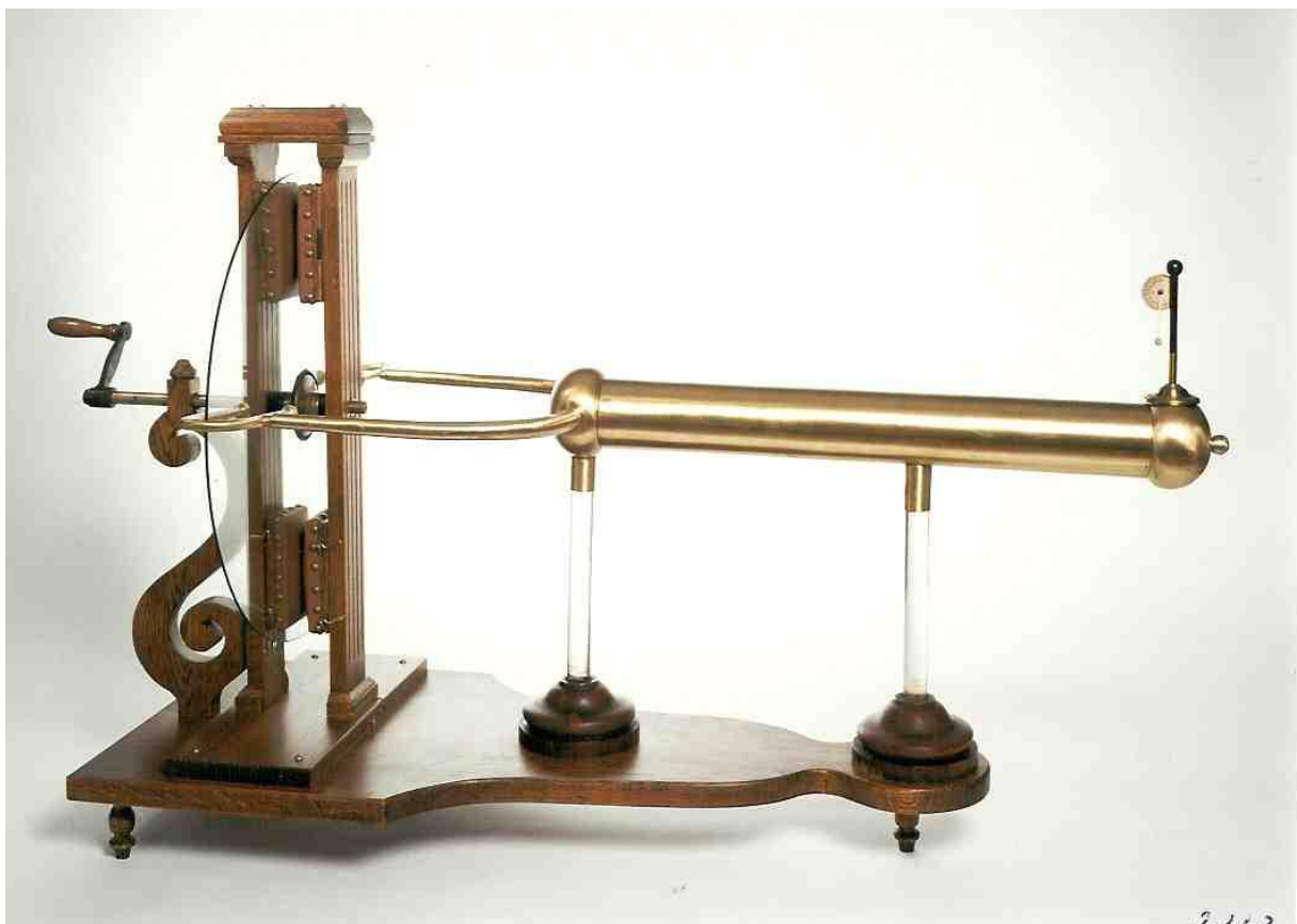
Elektriseermachine van Ramsden > het Engelse model
