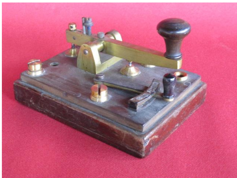
Het meer klassieke model van een Engelse seinsleutel met omschakelaar 'send - receive'.
